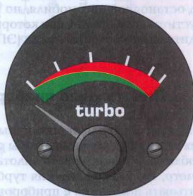
Рис. 3.26. Манометр для измерения давления турбонаддува:
