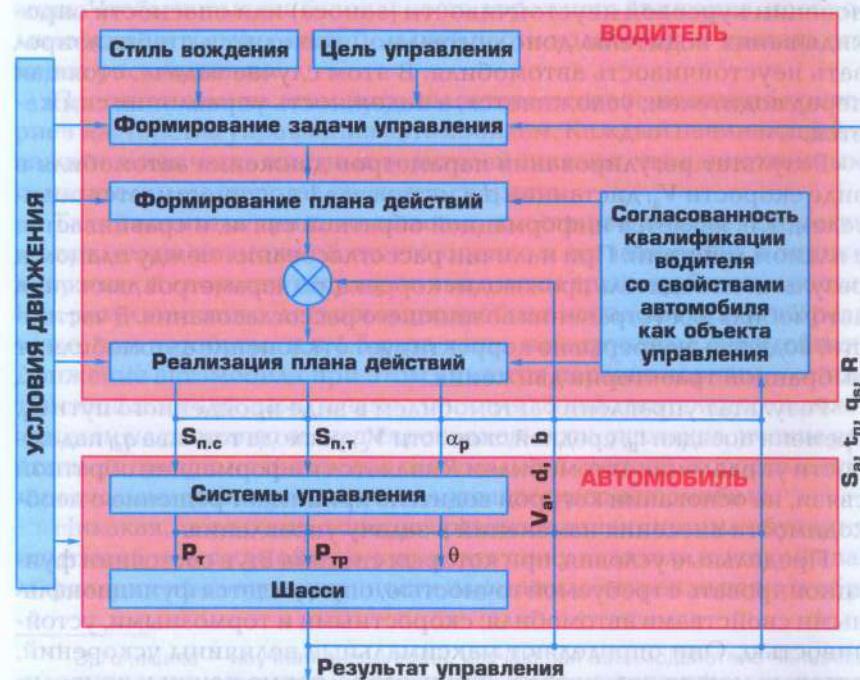
Рис. В.2. Структурная схема системы водитель—автомобиль
